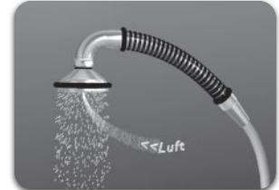
Das in den Duschkopf einfließende Wasser strömt durch eine Wirbelkammer (1). In der Wirbelkammer wird ein schnell rotierender, rechtsdrehender Wirbel erzeugt, welcher sich im Brausekopf (2) fortsetzt. Auf Grund der Sogwirkung des Wirbels wird in das Zentrum des Brausekopfes Luft eingesaugt. Diese Luft wird im Wirbel so mit dem Wasser vermischt, dass im Brausekopf ein Schaum (3) entsteht. Dieser Schaum tritt dann aus den Brauselöchern des Brausekopfes in Form einzelner Wasserblasen (4) aus.
